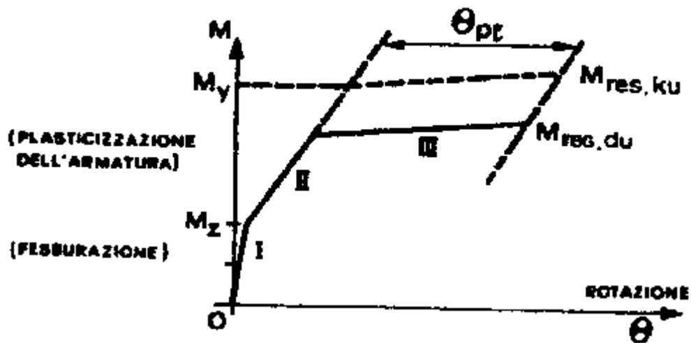
Fig. 1 - Diagramma momento-rotazione: idealizzazione tri-lineare
