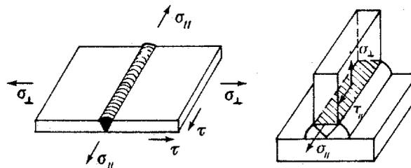
Stato tensionale nelle saldature a completa penetrazione<sup>1</sup>
