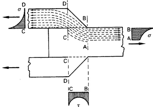
Flusso di tensioni attraverso la saldatura<sup>1</sup>
