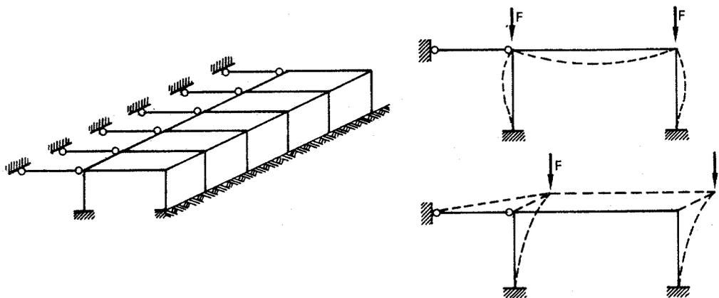
Influenza della tridimensionalità sull'instabilizzazione della struttura<sup>1</sup>
