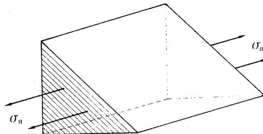
Stato tensionale nella sezione trasversale del cordone di saldatura<sup>1</sup>
