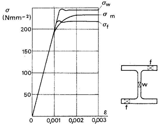
confronto tra risultati di prova a trazione e prova a compressione globale<sup>1</sup>
