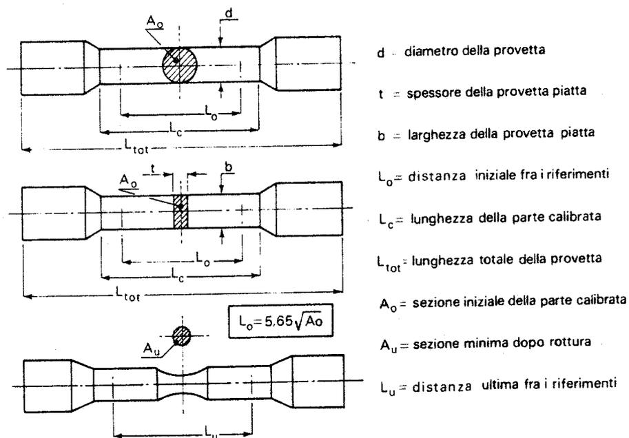
Caratteristiche geometriche del provino<sup>1</sup>
