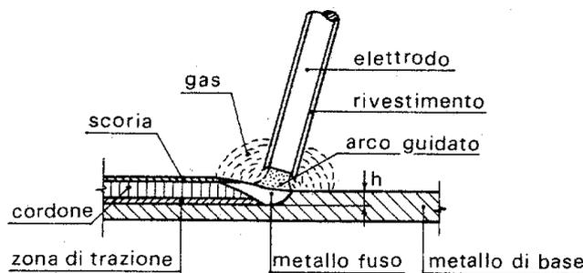
Saldatura ad arco con elettrodi rivestiti<sup>1</sup>
