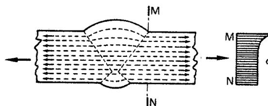
Flusso delle tensioni in una saldatura a completa penetrazione<sup>1</sup>
