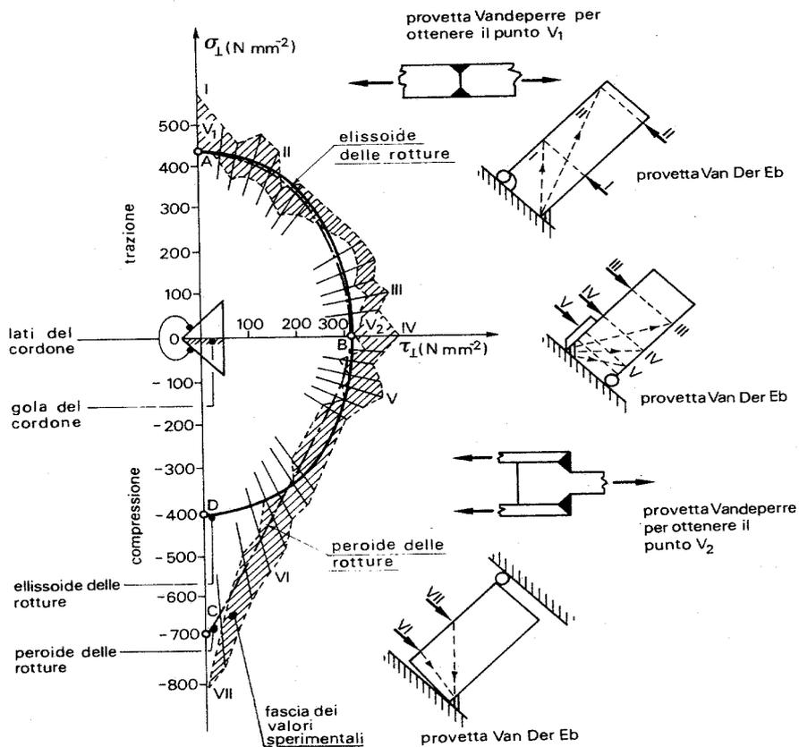
Peroide e tipi di provette utilizzati per ottenere i punti diversi del dominio di rottura<sup>1</sup>
