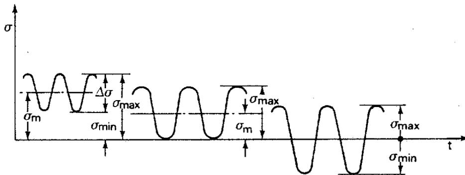
cicli di tensione nella prova a fatica<sup>1</sup>
