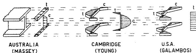
modelli proposti per l'andamento delle tensioni residue<sup>1</sup>
