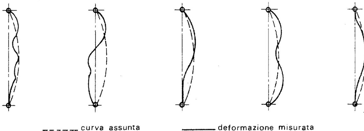
deformate reali e deformata sinusoidale usata nel modello<sup>1</sup>
